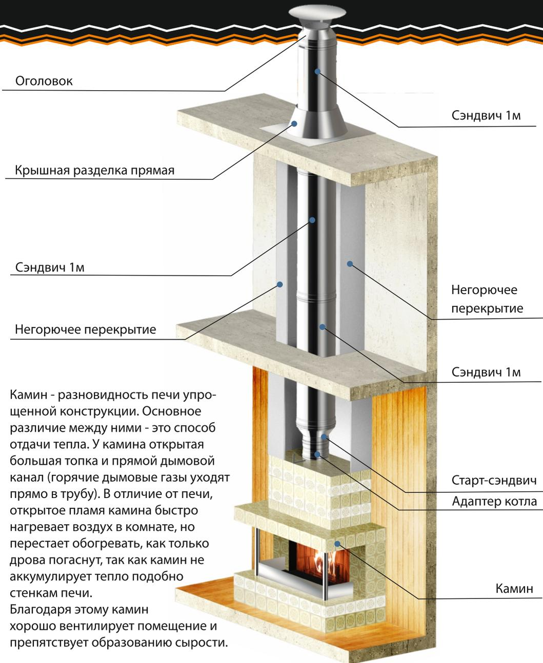
Камин - разновидность печи упрощенной конструкции. Основное различие между ними - это способ отдачи тепла. У камина открытая большая топка и прямой дымовой канал (горячие дымовые газы уходят прямо в трубу). В отличие от печи, открытое пламя камина быстро нагревает воздух в комнате, но перестает обогревать, как только дрова погаснут, так как камин не аккумулирует тепло подобно стенкам печи.
